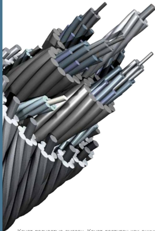
Канат полностью смазан. Канат доступен как оцинкованный, так и неоцинкованный. • Средний коэффициент заполнения 0.700 • Тип свивки: односторонняя • Номер категории каната (RCN) определяет количество оборванных внешних прядей, указывая на отбраковку каната согласно ISO 4309: RCN=23-2
